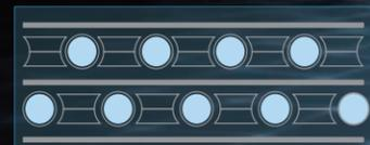
室内机采用换热效率更高的致密翅片，提高效率
