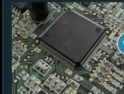
采用 SMT 封固技术的电脑控制板表面
